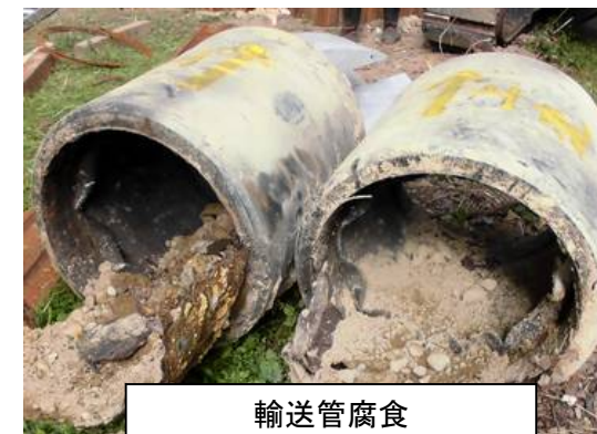
輸送管腐食(約1700X200mm) 2016年8月(浜風町10)
